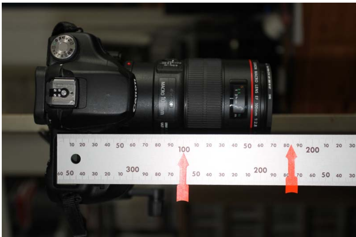
Abb. 5 Lage der Hauptebenen beim Objektiv EF 100 mm Makro
