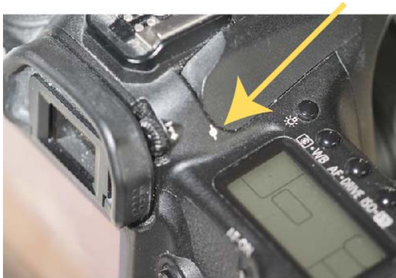
Abb. 4: Markierung der Sensorebene
